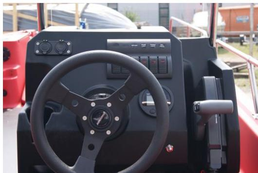
Steuerkonsole (klein) mit hydraulischer Lenkung
